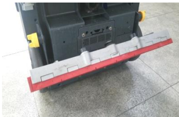
청소 및 유지보수 가 용이한 스퀴지 장착
